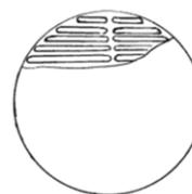
Рис. 2. Сита для анализатора АЛГ-М
