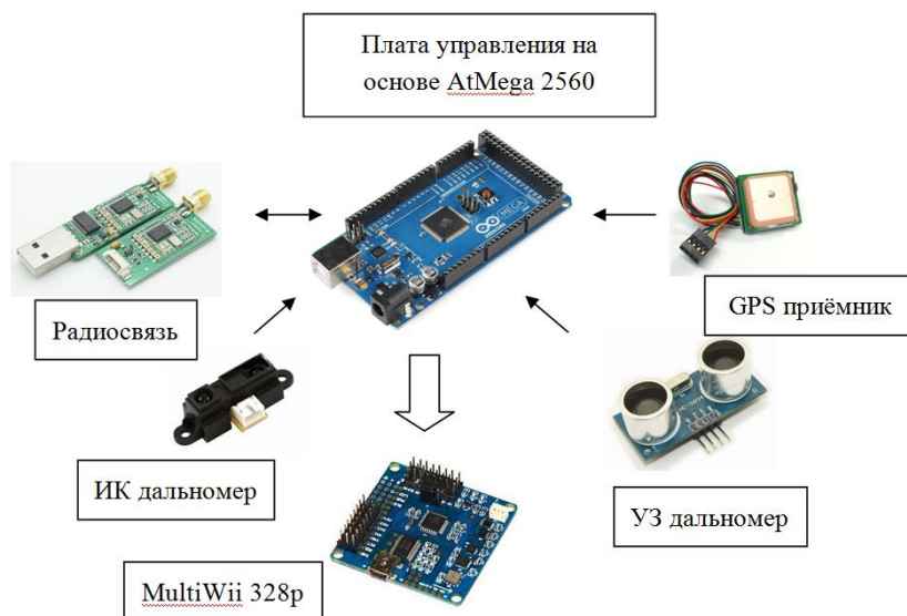
Рисунок 1. Структура системы автоматического пилотирования
