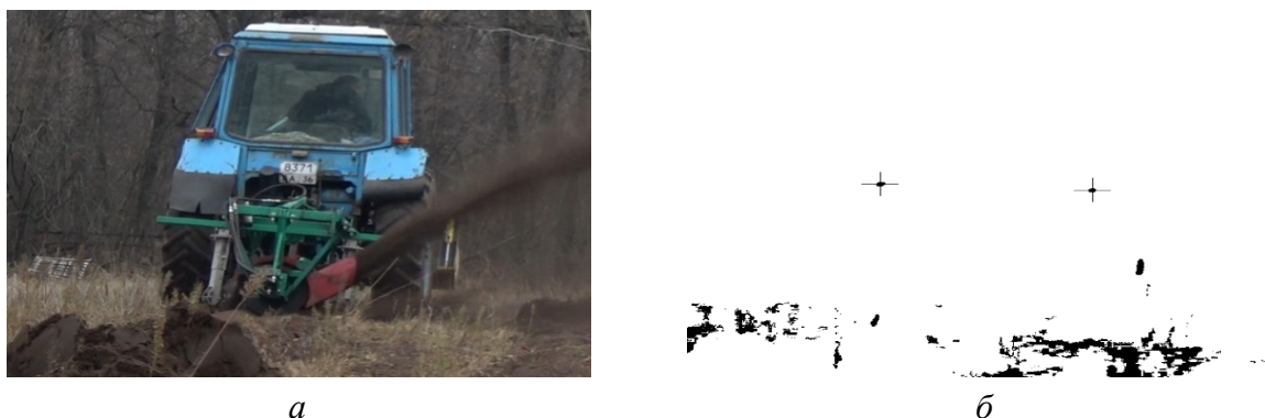
Фото 1. Пример кадра из видеозаписи экспериментального исследования: a — кадр из видеозаписи; б — найденные задние указатели поворота трактора на жёлтом канале изображения
