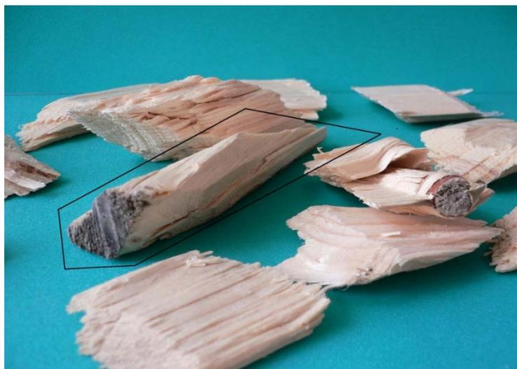
**Фото 7.** Крупная фракция щепы. Частица щепы с углом среза  $12^\circ$ , получившаяся из короткомера (выделена)
