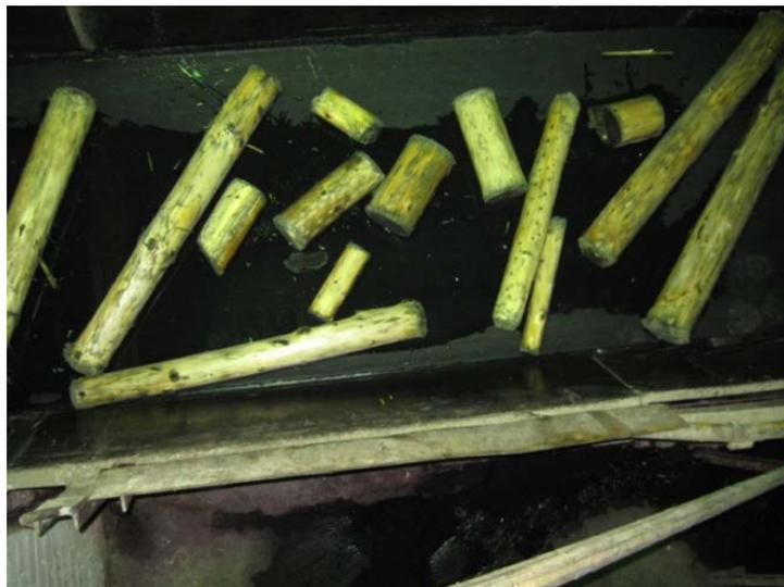
**Фото 3.** Конвейер подачи сырья в рубительную машину
