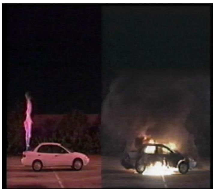
**Фото 2.** Продолжение аварии. Время: 1 мин, 0 с. Водородный поток спадает, пожар транспортного средства на бензине начинает увеличиваться
