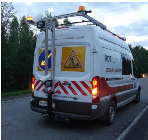
**Фото 1.** Комплекс измерительный аэродромно-дорожный (лаборатория КП-514)
