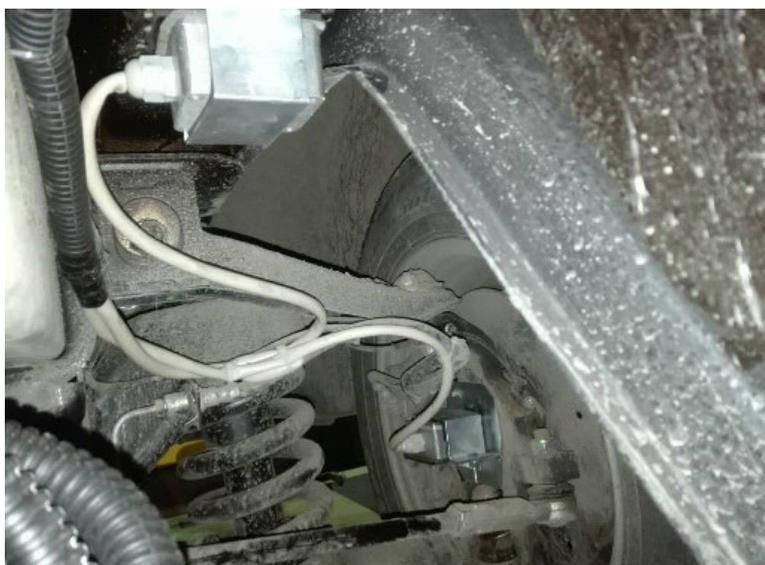
**Фото 2.** Акселерометрический датчик
