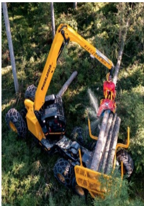
Фото 3. Харвардер на базе ВТПМ компании Konrad Forsttechnik (фото авторов)
