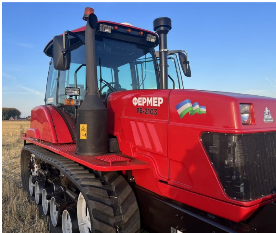
Фото 7. Сельскохозяйственный трактор на резинометаллических гусеницах «Фермер» РБ-2103 [140]
