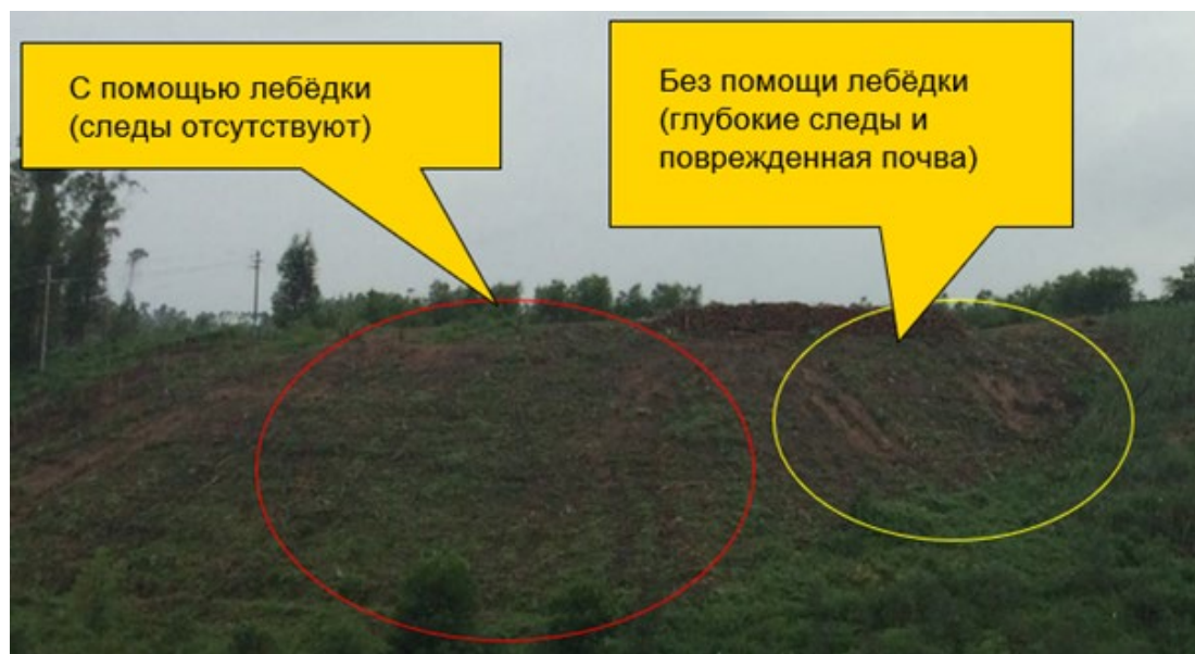
Фото 16. Сравнительный вид последствий работ лесных машин на склоне с использованием и без использования лебёдки [121]
