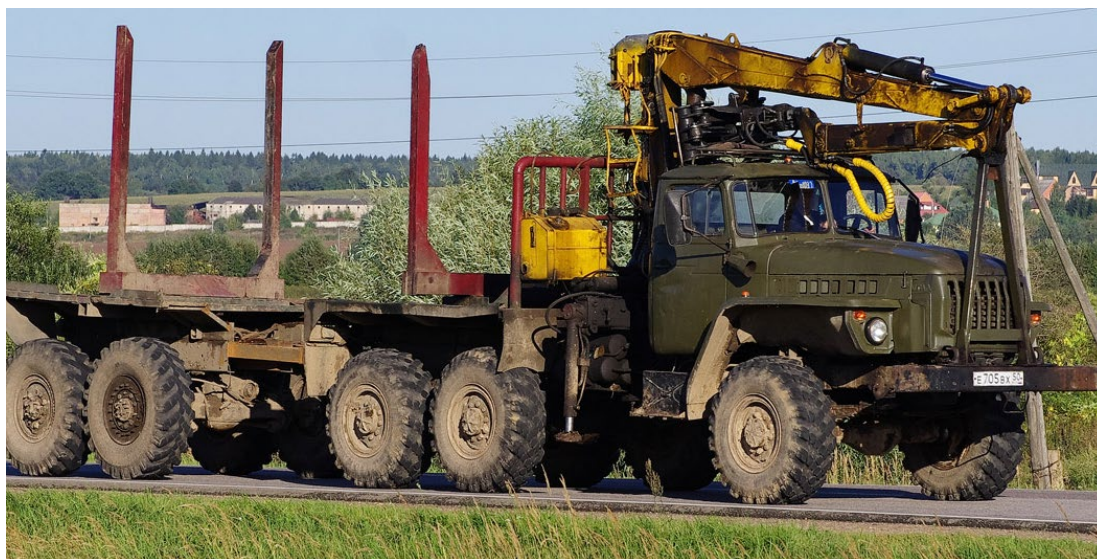
Фото 10. Самопогружающийся автолесовоз (с гидроманипулятором) [42]
