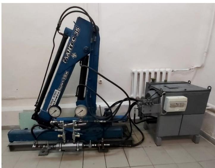
**Фото.** Общий вид гидроманипулятора ЛВ-210-01 с новым демпфером и насосной станцией [фото авторов]
