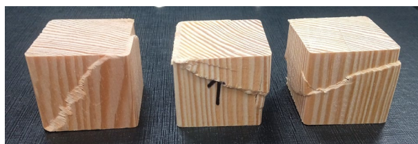
Фото 2. Образцы без отверстий после испытаний [рисунок автора]
