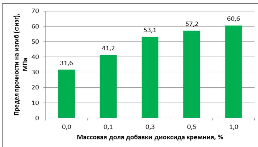
**Рисунок 8.** Предел прочности при изгибе в зависимости от концентрации аморфного диоксида кремния [рисунок авторов]
