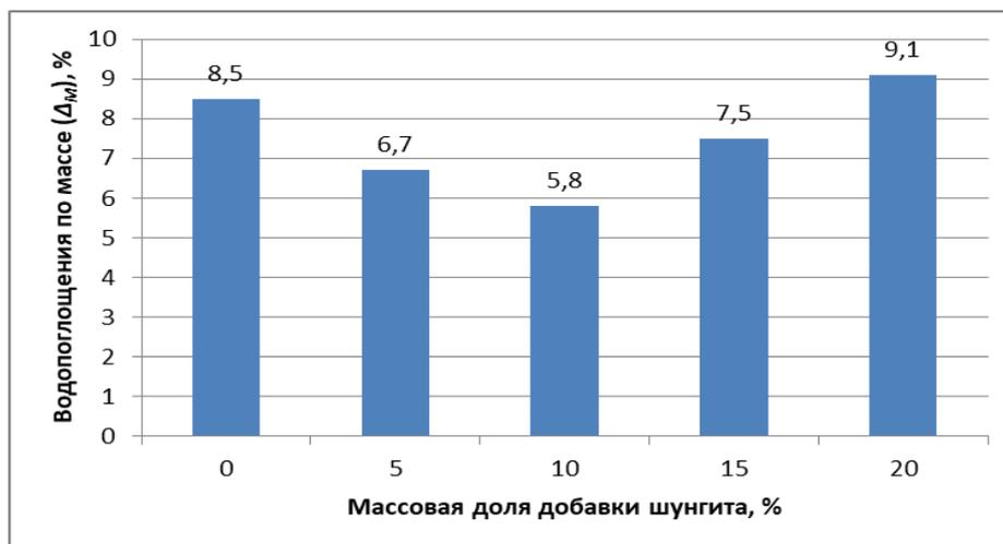
**Рисунок 7.** Зависимости водопоглощения плит от концентрации наношунгита [рисунок авторов]
