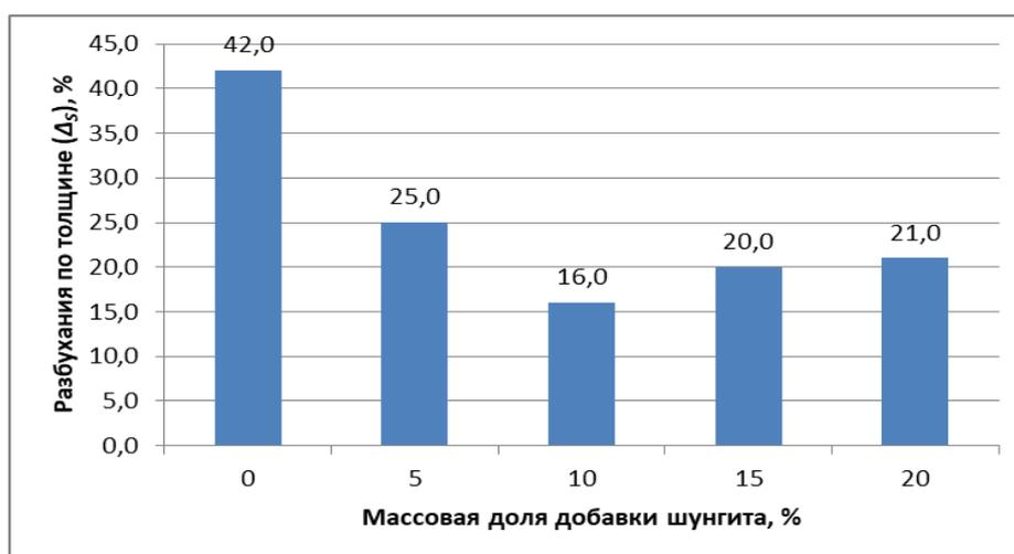
**Рисунок 6.** Зависимости разбухания от концентрации наношунгита [рисунок авторов]
