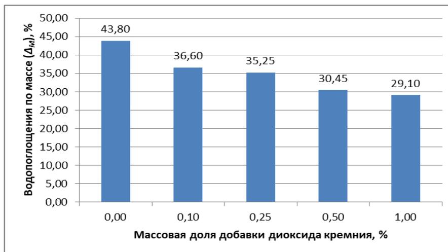
**Рисунок 11.** Зависимость показателя водопоглощения плит от концентрации аморфного диоксида кремния [рисунок авторов]
