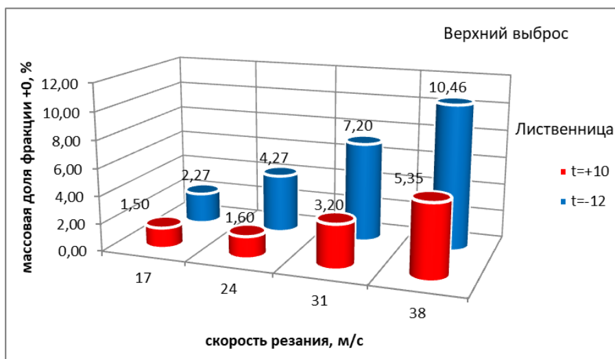
Рисунок 16. Влияние скорости резания и температуры измельчаемой древесины на массовую долю фракция +0 для лиственничных балансов при верхнем способе выброса щепы [рисунок авторов]
