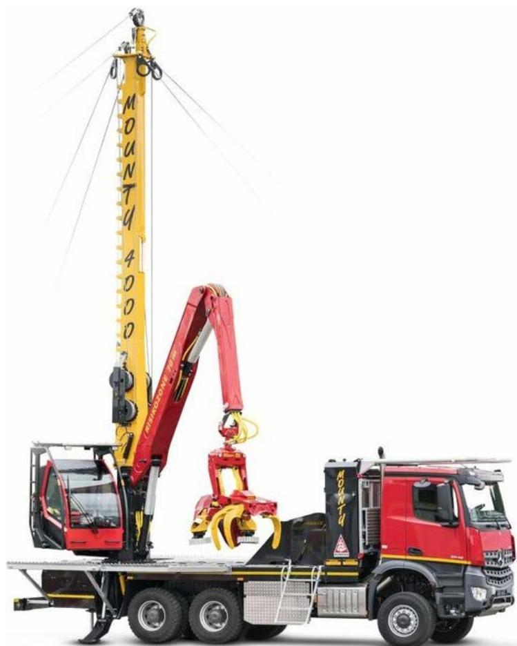
**Фото 5.** Общий вид компоновки горного процессора компании Konrad Forsttechnik GmbH (фото с сайта компании Konrad Forsttechnik GmbH)
