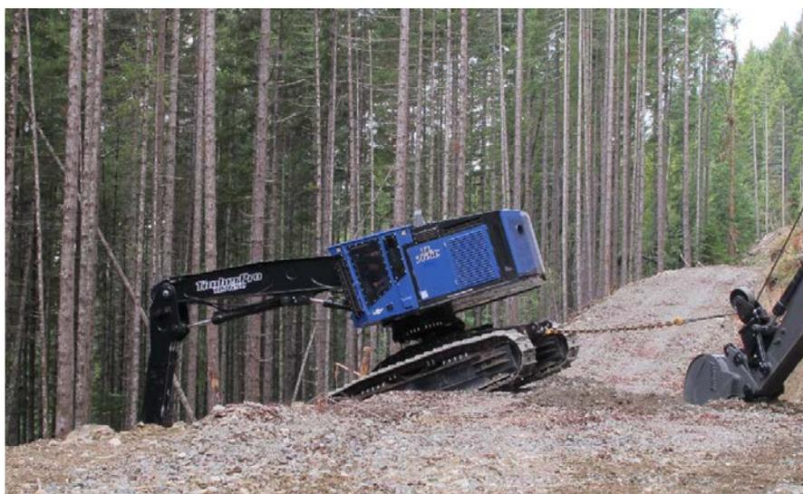
**Фото 11.** Валочно-пакетирующая машина спускается на горный склон, удерживаемая самоходной лебёдкой на экскаваторной базе Summit Winch Assist (фото авторов)
