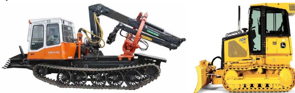
Фото 8. Визуальное сравнение ходовой части лесного и строительного тракторов
