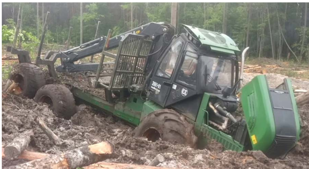
Фото 10. «Затопление» колёсного форвардера при плохих почвенно-грунтовых условиях
