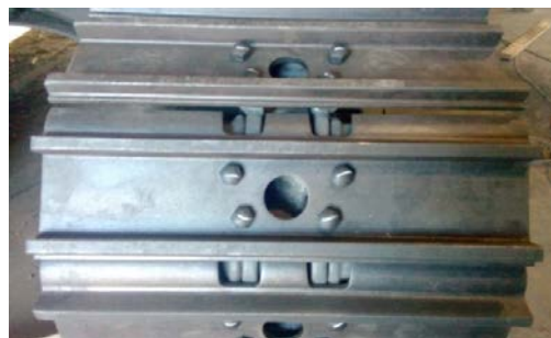
Лесной трак гусеничного харвестера (700 мм, два гребнезацепа)
