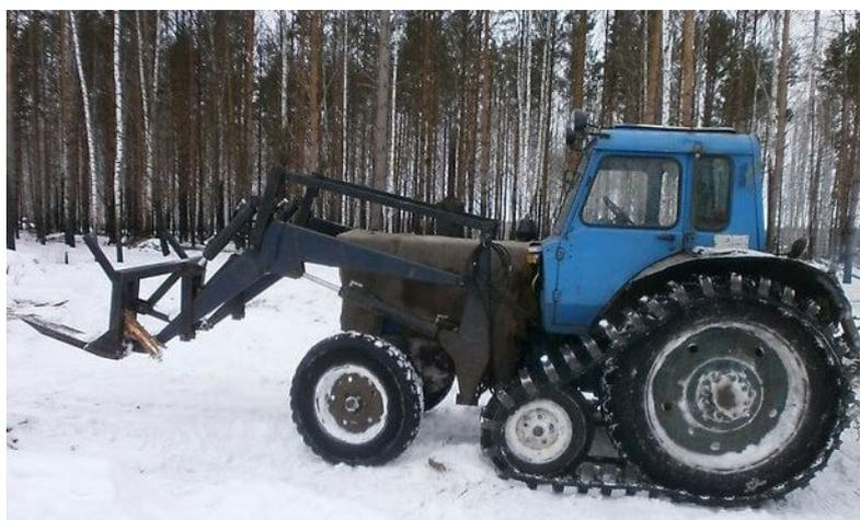
**Фото 1.** Трактор МТЗ с полугусеничным движителем (фронтальный погрузчик)
