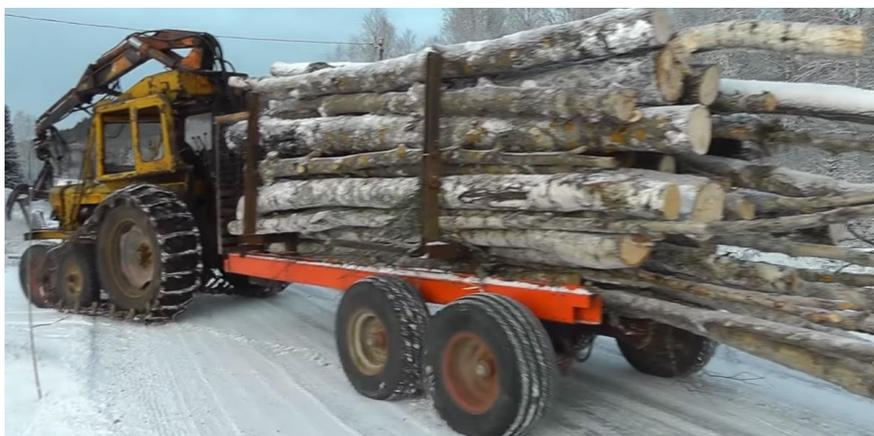
**Фото 2.** Форвардер на базе трактора на полугусеничном ходу [фото авторов]
