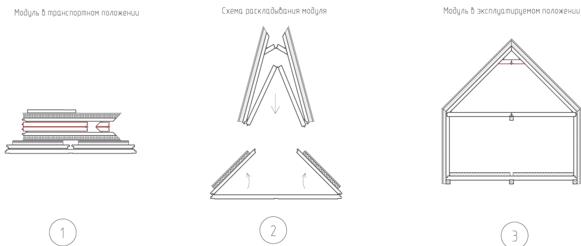
Рисунок 8. Предлагаемая концепция складного (трансформируемого) модуля [рисунок авторов]
