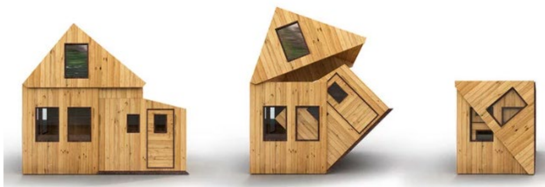
Рисунок 4. Схема трансформации модуля RUSTIC компании Brette House [ https://i.piniing.com/736x/e4/9d/01/e49d016f76bf0c1239b3ab46d391d388.jpg ]
