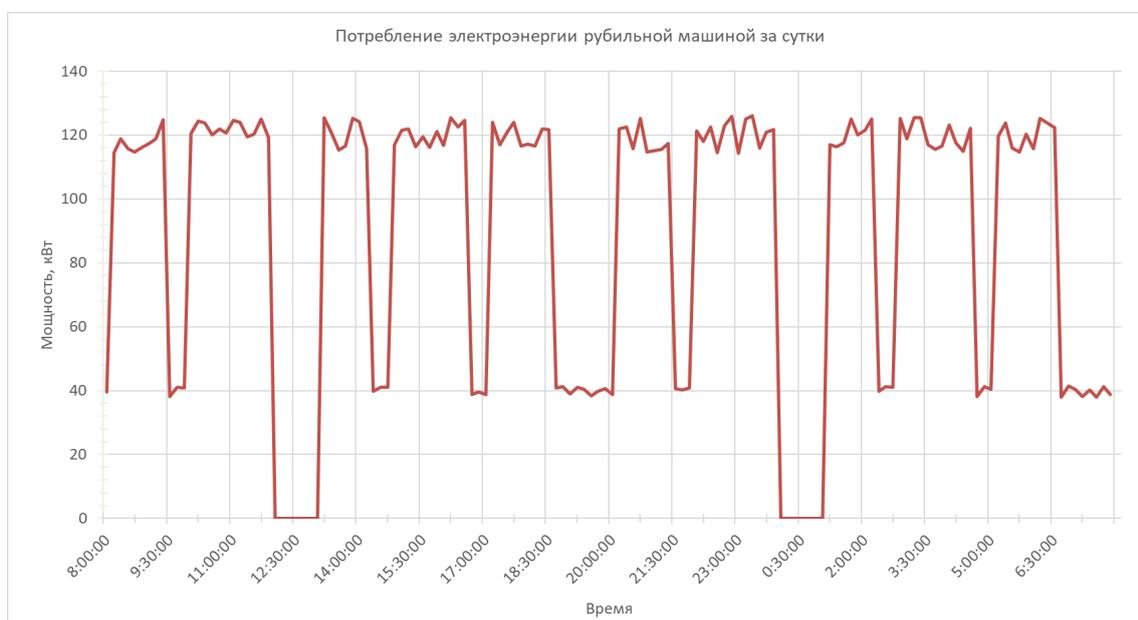
**Рисунок 2.** График мощности, потребляемой рубительной машиной за сутки [рисунок авторов]
