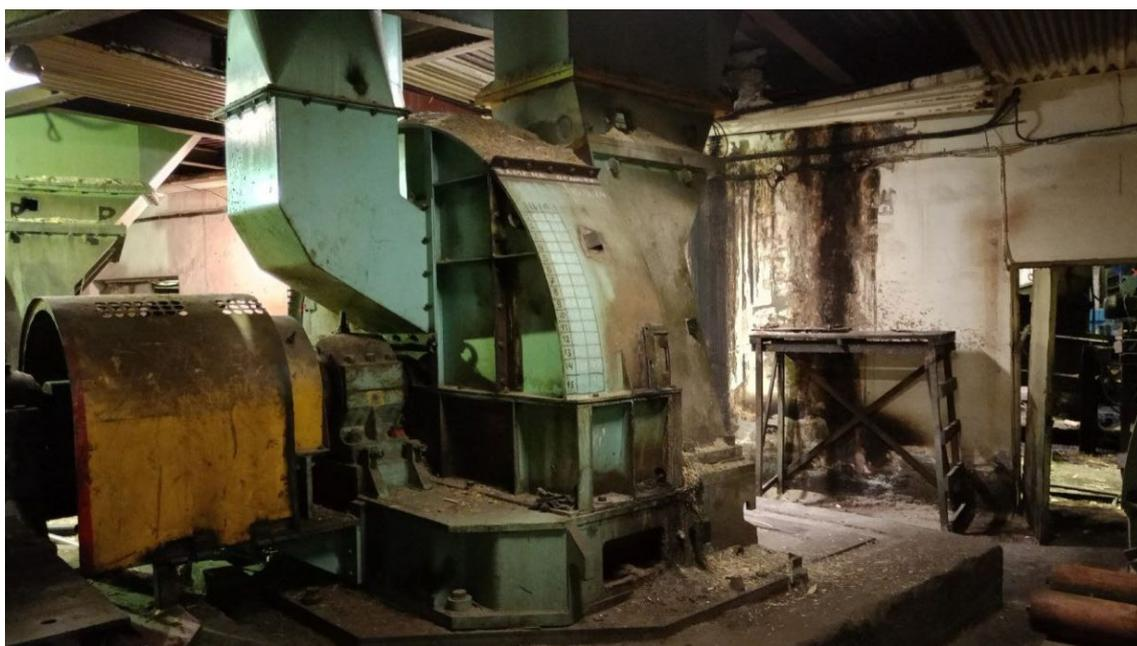
**Фото 1.** Рубительная машина МР5-150 с приводом от электродвигателя [фото авторов]
