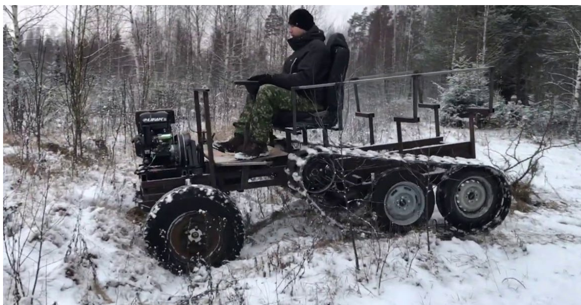
Фото 6. Лесной мини-трактор на базе мотоблока и тракторного адаптера на полугусеничном ходу [22]
